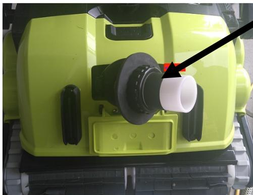
Der Standard Sauganschluss des Poolroboters hat einen  $\text{\O} 37\text{mm}$  und muss auf  $\text{\O} 38\text{mm}$  vergrössert werden.
