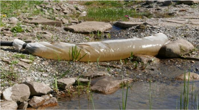
Der Feinfiltersack ist aus einem **sehr dichten Spezialgewebe** aus Kunstfaser gefertigt und filtert Partikel bis zu **50 Mikron** aus, um so das wertvolle Wasser bei der Teichreinigung wieder in den Teich zurückzuführen.
